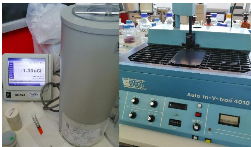
Figura 14: En la izquierda el contador de pozo, en la derecha el equipo Auto-in Vtron 4010
